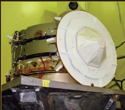
Рисунок 2. Бортовая аппаратура радиоэлектронного наблюдения Corperfield-2
