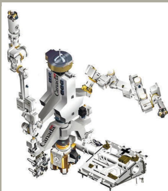
Рис. 10. Манипулятор для специальных целей SPDM (Special Purpose Dexterous Manipulator) – Dextre (по материалам сайта [20])
