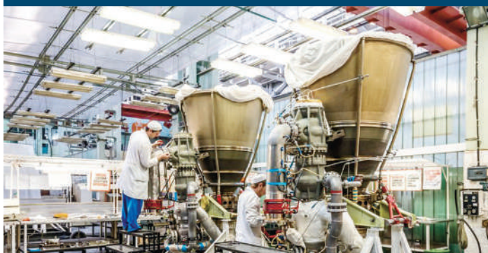
Двигатели в процессе сборки в НПО «Энергомаш»
