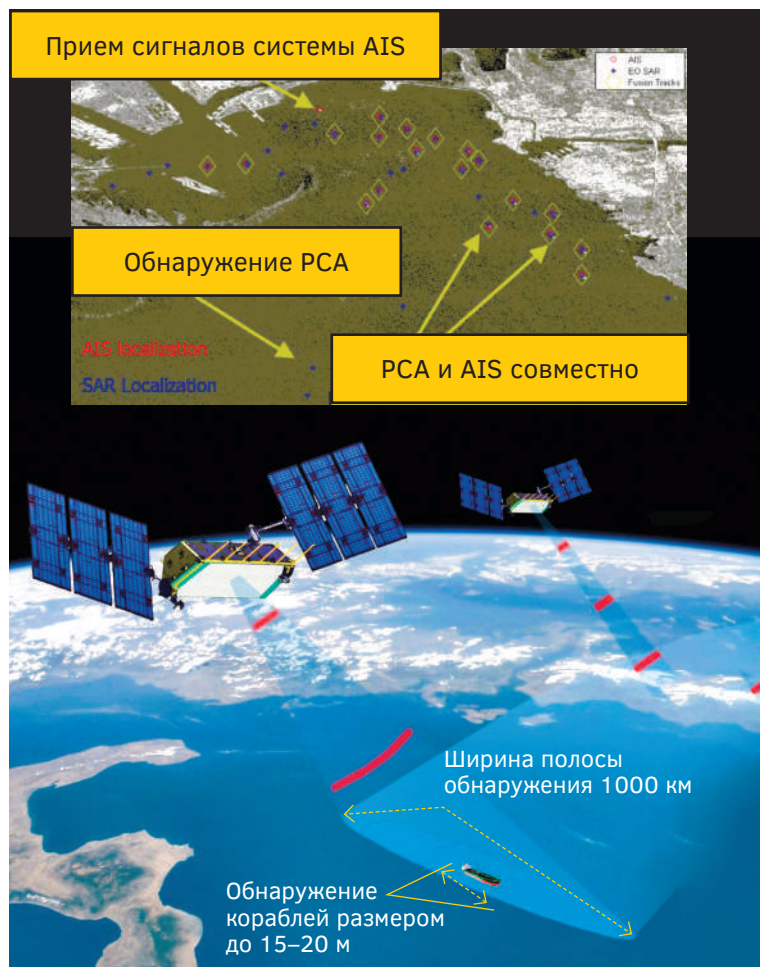
Рис. 5. Проект космической системы STELLA MARINE. Орбитальная группировка в составе 20 КА с РСА и приемником сигналов системы AIS для слежения за кораблями с периодичностью 1 час, разрабатывается компанией Thales Alenia Space
