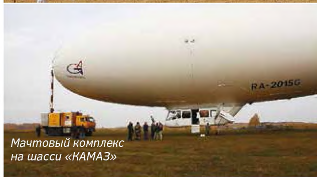
Рис. 6. Мобильные экспедиционные причально-мачтовые системы
