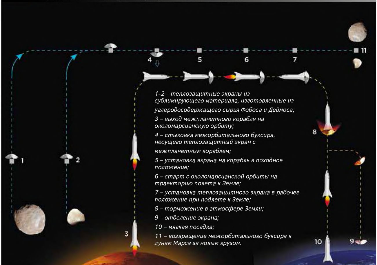
Рис. 4. Схема запуска РН к Земле и оснащения межпланетной ракеты теплозащитной оболочкой, произведенной из сырьевых ресурсов Фобоса и Деймоса:
