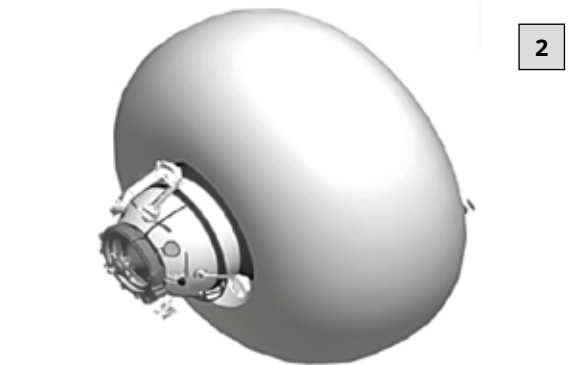
Рис. 7. ЦКР для ИГ: 1 — вид ЦКР 1-го поколения, СССР (1978); 2 — перспективный трансформируемый модуль для новой ЦКР, РКК «Энергия» имени С. П. Королёва, Россия (2016), по: Орлов, Колотева, 2017 [6, с. 15, 16]
