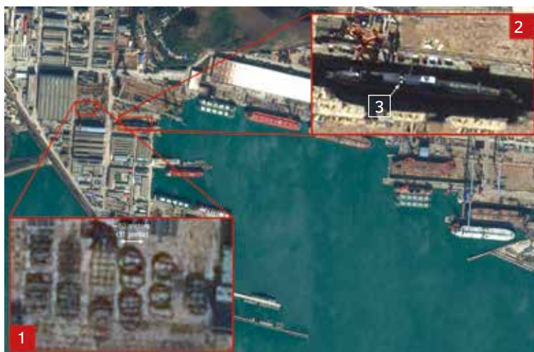
Рис. 5. Верфь в Huludao: 1 – секции корпусов ПЛАРБ; 2 – ПЛАРБ класса JIN (проект 094); 3 – ракетные шахты в открытом состоянии
