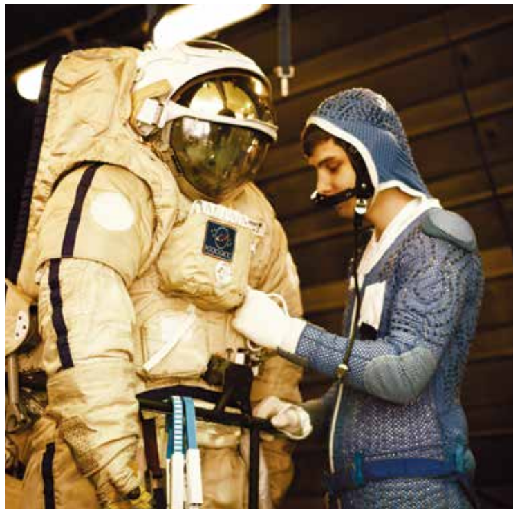
Испытания очередных усовершенствований скафандра «Орлан-МКС». Артем Шибалов — инженер первой категории — и Андрей Радзивинович — техник (слева направо)
