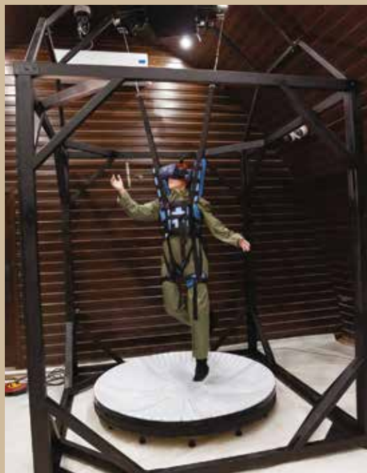
Испытания подвесного стенда для виртуальных прогулок по Луне
