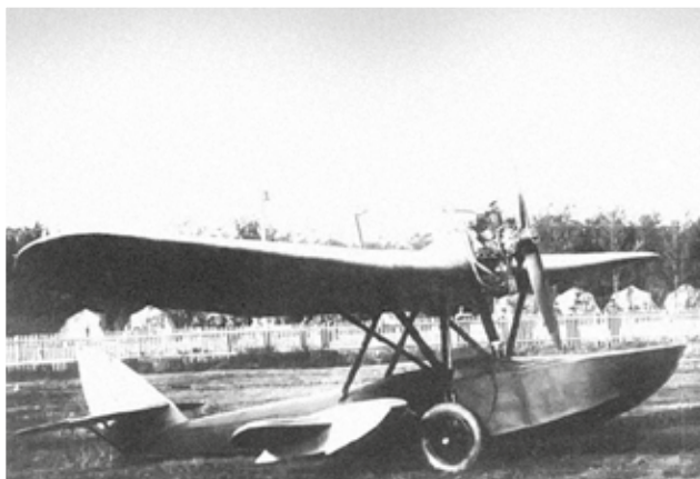
Рис. 10. Первый самолет с убирающимся шасси, построенный в России / СССР: амфибия Ш-1
