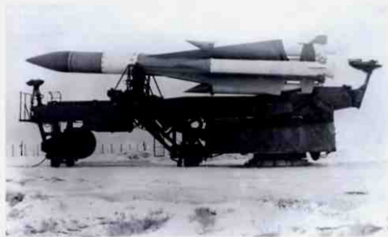
Автоматическое заряжение пусковой установки системы С-200
