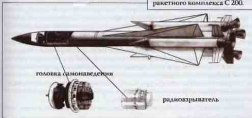
Устройство ракеты для зенитного ракетного комплекса С 200.
