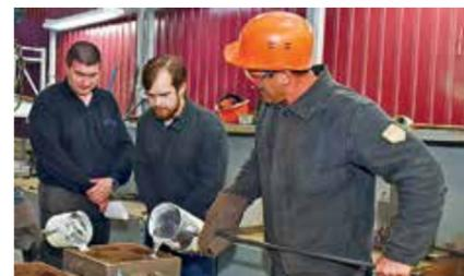
В цехе №68 идёт освоение литья из нового трёхкомпонентного сплава ВАЛ 14. Полученные детали будут использоваться при сборке одного из специзделий.
