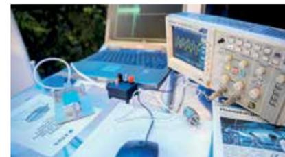
В АПКБ завершены опытно-конструкторские работы по теме «Разработка волоконно-оптического датчика вращения». Новинка выпущена на рынок и была представлена на МАКС-2021. Прибор предназначен для систем беспилотных летательных аппаратов и специальной техники – помогает им ориентироваться в пространстве. Технология производства ВОГ существенно отличается от технологии изготовления обычных гироскопов и содержит целый ряд новых технологических процессов.
