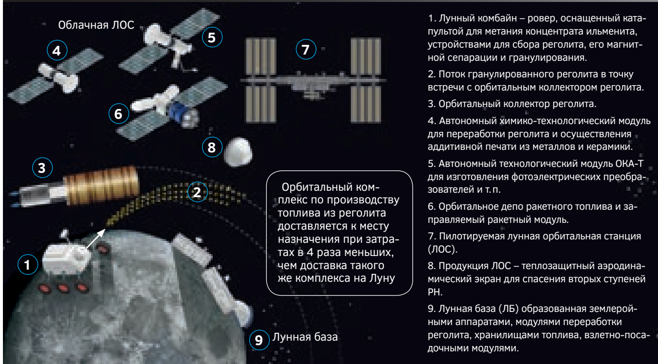
РИС. 3 Технология полного спасения РН для повторного использования
