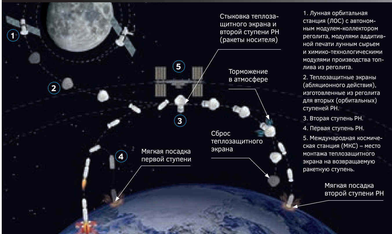
РИС. 3 Технология полного спасения РН для повторного использования
