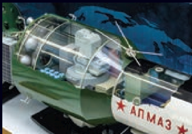
Макет орбитальной станции «Алмаз». В разрезе видно расположение фотоаппарата «Агат 1», занимавшего большую часть объема рабочего отсека. Рядом с макетом фотоаппарата видно восемь капсул специнформации
