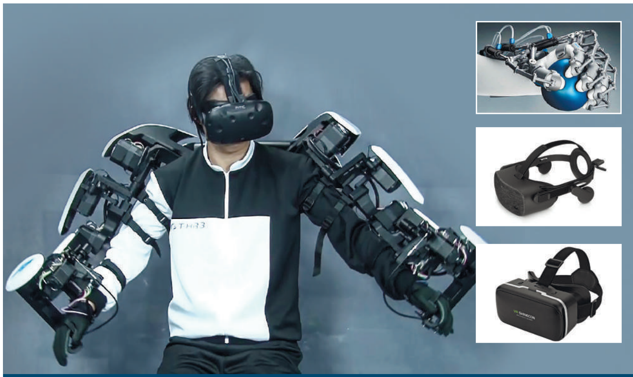
Рис. 2. Экзоскелет – костюм телеприсутствия – и его элементы
