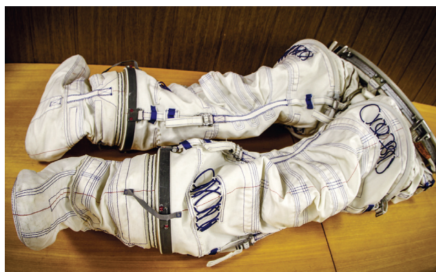
Оболочки ног перед заменой
