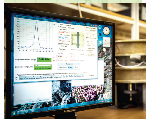
В действии измерительно-вычислительный комплекс для определения электромагнитных СВЧ-параметров ферритов и парамагнетиков
