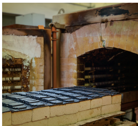
Ферритовые детали после обжига в печи с выдвигающимся подом
