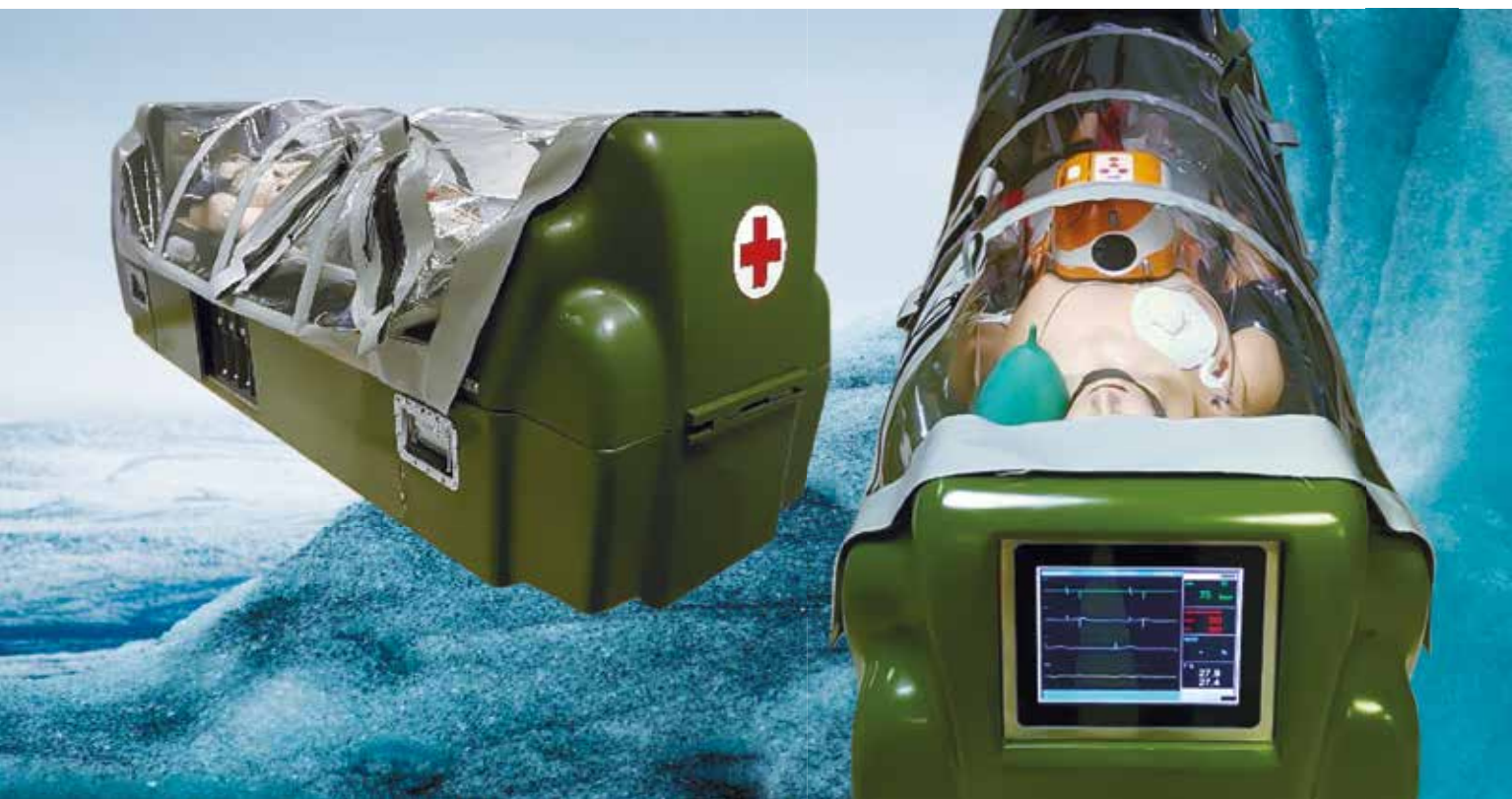
Рис. 1. Многофункциональная медицинская роботизированная система (ММРС) «Спасатель» и ее наиболее востребованные компоненты (дефибриллятор, кардиокомпрессор, аппарат искусственной вентиляции легких, аппарат мониторинга жизненно важных функций, экспертная система, аппарат инфузионных шприцевых дозаторов и др.)
