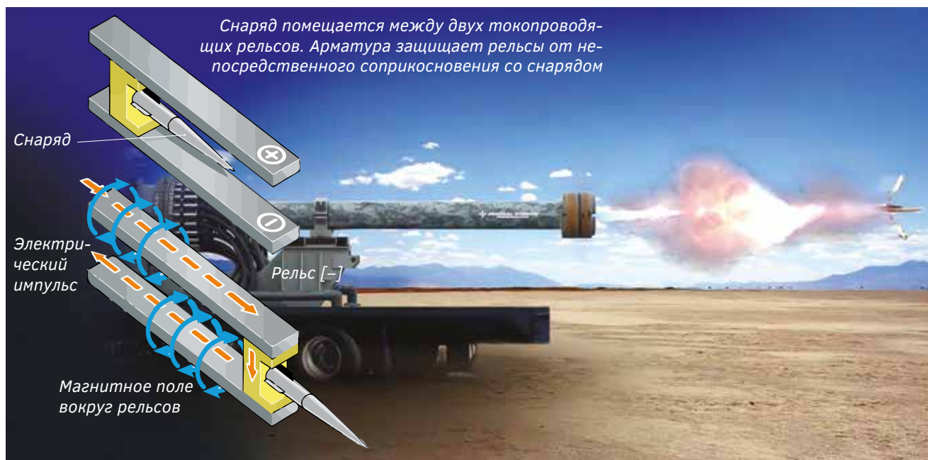
Рис. 6. Электромагнитная индукционная рельсотронная пушка
