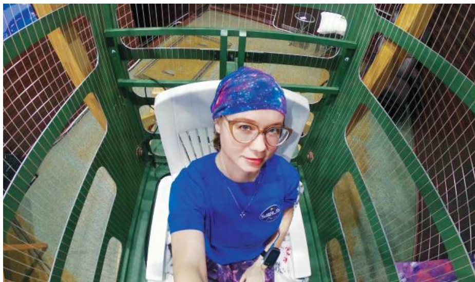
Внутри экранирующей установки «АРФА», которая работает по принципу клетки Фарадея
